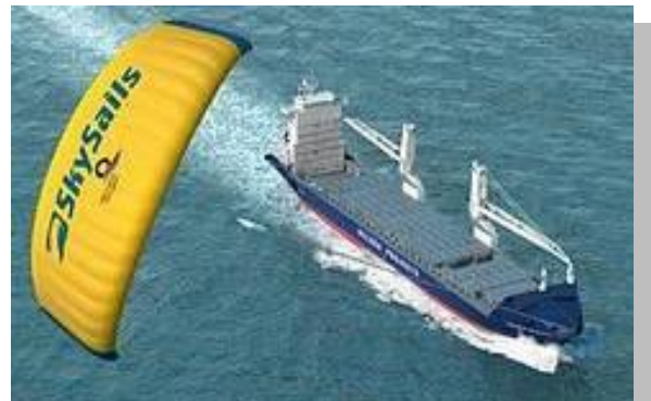
Een koopvaardijship uitgerust met een 'towing kite' Aanzienlijke brandstofbesparing kan worden bereikt op lange afstandsreizen. Bij voorbeeld bij het oversteken van de oceanen.
