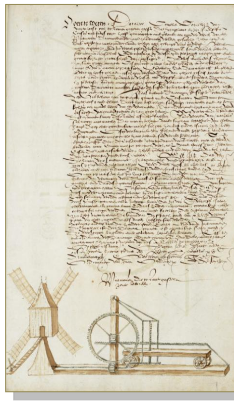
Het originele octrooi van 15 december 1593 voor de uitvinding van de houtzaagmolen op windkracht. Rechts de schets van de wipmolen, de krukas en het 'krabbelrad'
